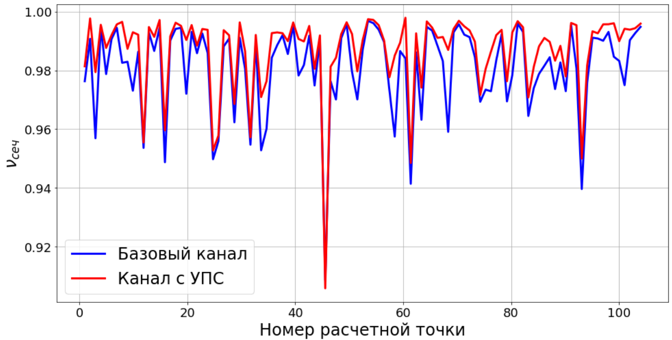
Рисунок 6.10 – Сравнение величин v_{сеч} до и после применения адаптивной системы УПС
