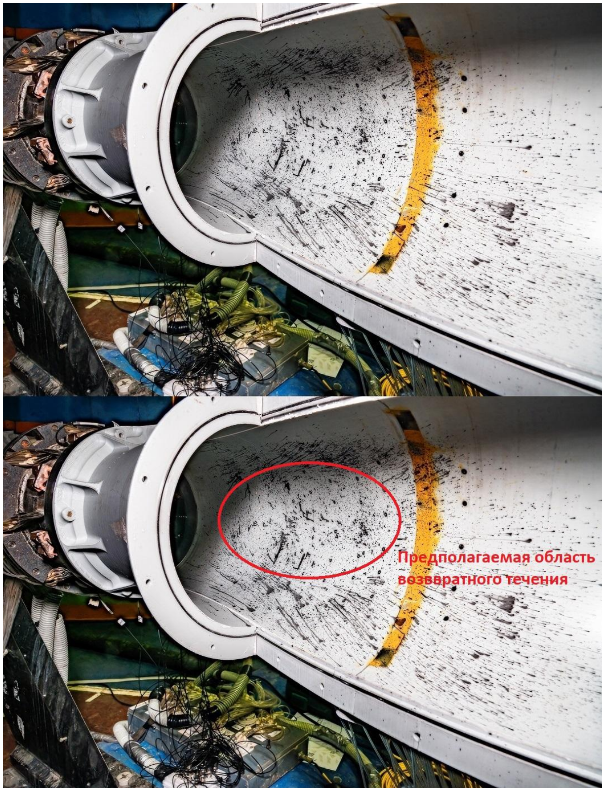
Рисунок 5.22 – Поверхностные линии тока, базовый канал, G_{\text{вх}} \cong 4.2 кг/с
