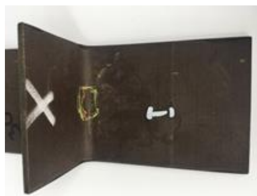
в) Образец после удара 30 Дж.
