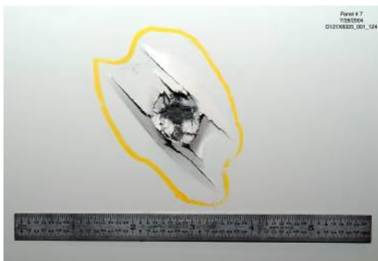
Рисунок 1.11 – Надёжно обнаруживаемое повреждение в панели крыла Boeing 787, полученное в результате удара с энергией 900 Дж [31]
