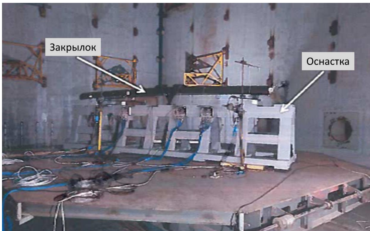
Рисунок 4.2 – Натурные испытания закрылка в РК-1500
