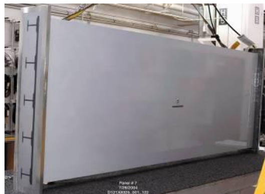
Рисунок 1.11 – Надёжно обнаруживаемое повреждение в панели крыла Boeing 787, полученное в результате удара с энергией 900 Дж [31]
