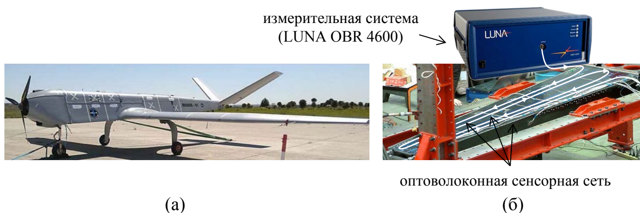
Рисунок 1.8 – Применение распределённой системы измерения деформаций при испытаниях БПЛА ((а) – БПЛА MILANO; (б) – установка для испытания кессона крыла БПЛА с установленной системой LUNA (п. 1.8))
