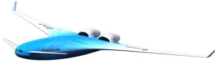
Рис. 1 – Самолет схемы типа «летающее крыло» с «утопленным двигателем»
