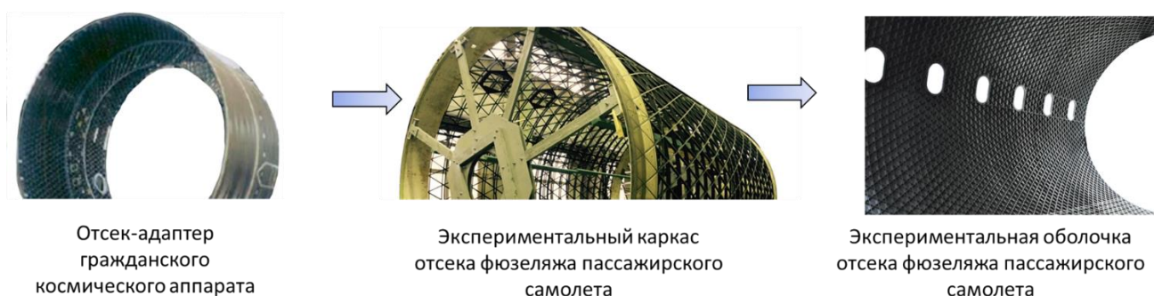
Рисунок 2 – Конструкции композитных отсеков с регулярной реберной структурой
