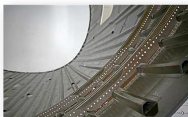
Оболочка фюзеляжа с сетчатой КСС, реализованная в АО «ЦНИИСМ»
