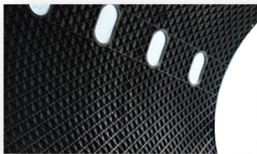
Оболочка фюзеляжа с сетчатой КСС, реализованная в АО «ЦНИИСМ»
