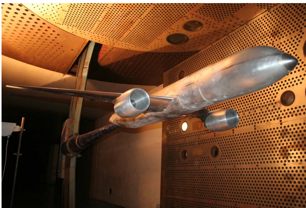
Рисунок 14 – Модель ДМС-21-1 в рабочей части АДТ Т-128
