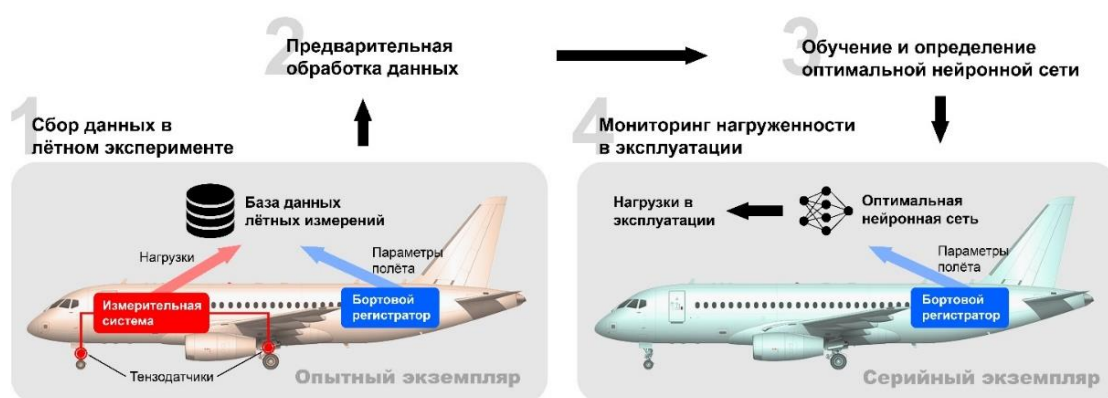
Рисунок 4.1 — Схема подхода к мониторингу нагруженности шасси транспортного самолёта с применением ИНС
