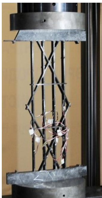
Рисунок 45 – Фрагмент сетчатой конструкции в испытательной машине
