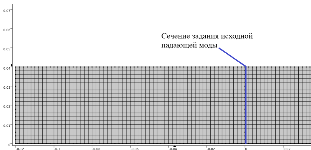
Рисунок 3.24 – Фрагмент сетки вблизи сечения задания исходной падающей моды для проведения расчетов с использованием МКЭ в плоском канале
