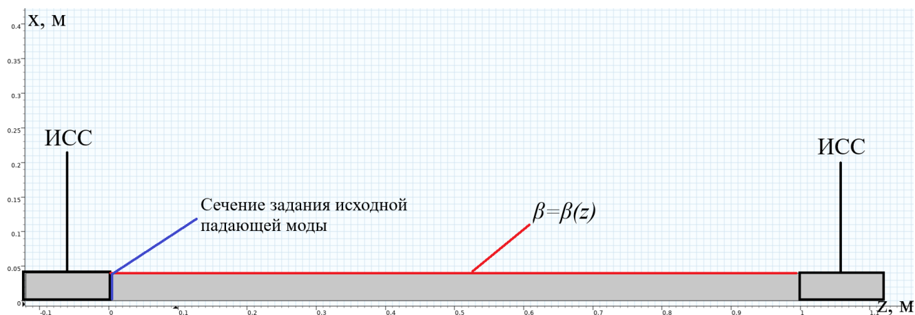
Рисунок 3.23 – Схема расчетной области для проведения расчетов с использованием МКЭ в плоском канале
