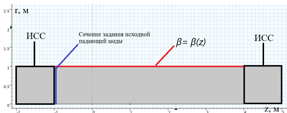
Рисунок 3.3 – Схема расчетной области для расчетов с использованием МКЭ в цилиндрическом канале в осесимметричной постановке
