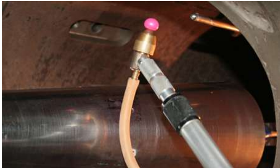
Рисунок 5.18 — Фотография приемника Пито — Прандтля и шарика в рабочей части УТ-1М.
