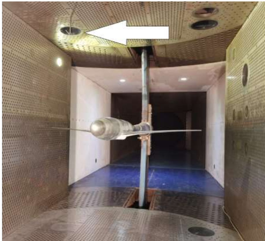
Рисунок 5.13 — Рабочая часть № 1 трансзвуковой аэродинамической трубы Т-128 с контрольной моделью и комбинированным приемником для измерения нестационарного полного и статического давления.
