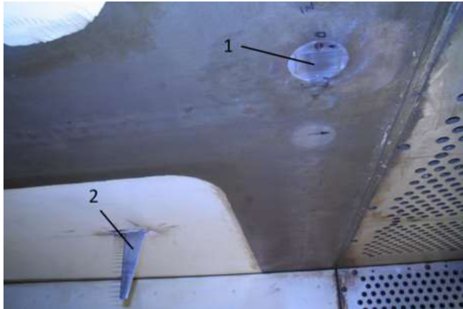
Рисунок 5.6 — Фотография размещения плавающего элемента (1) и гребенки приемников полного давления (2) в сопле аэродинамической трубы Т-128.
