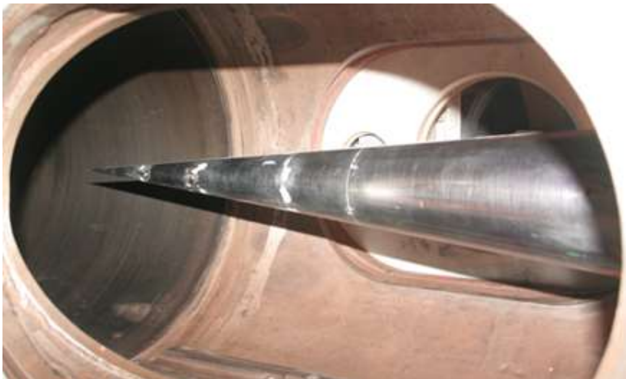
Рисунок 5.1 — Конус в рабочей части установки УТ-1М.
