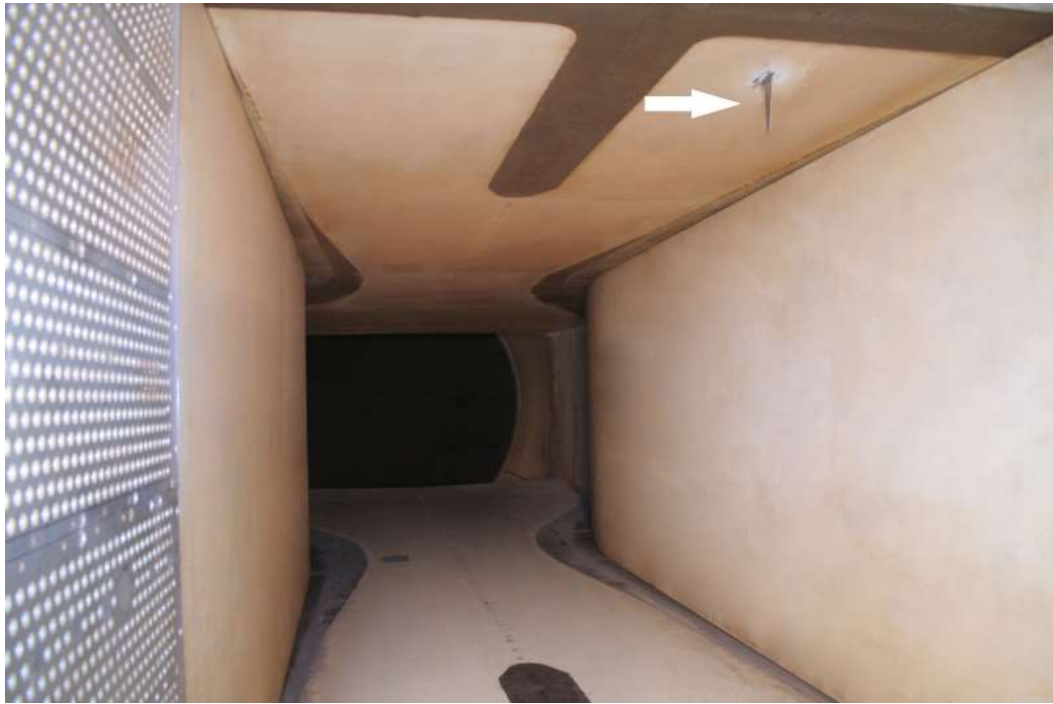
Рисунок 5.7 — Фотография регулируемого сопла аэродинамической трубы Т-128 с установленной на верхней стенке ребенкой [185].
