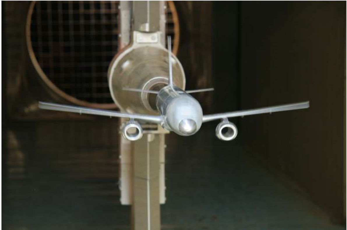
Рисунок 3 — Модель самолета SSJ-100, совершающая свободные колебания по крену в трансзвуковой аэродинамической трубе ЦАГИ Т-128.
