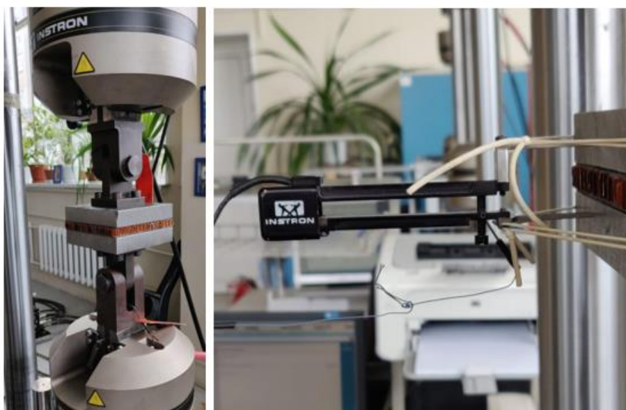
Рисунок 22 – Образец в испытательной машине с датчиком деформаций
