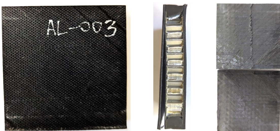
Рисунок 61 – Мода разрушения образца (FCF) - разрушение обшивки от
