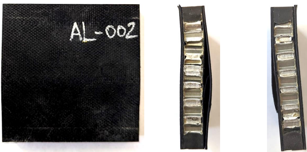
Рисунок 60 – Мода разрушения образца (FBF) - потеря устойчивости обшивки
