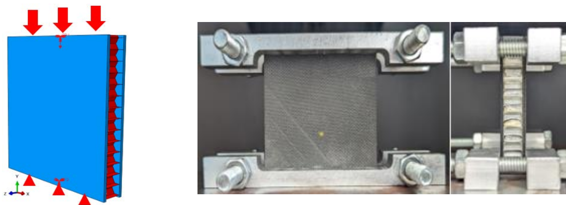
Рисунок 28 – Схема нагружения образца в МКЭ и эксперименте
