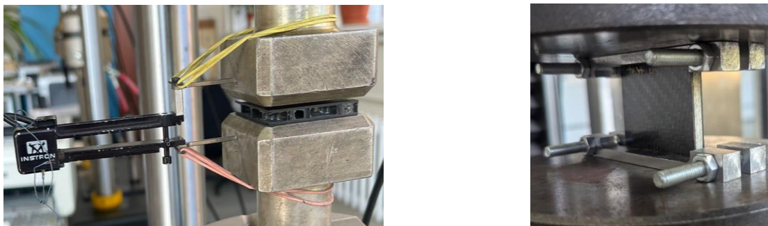
Рисунок 69 – Образцы в испытательной оснастке в процессе нагружения
