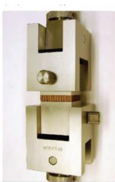
Рисунок 10 – Примеры оснасток для испытания трехслойных материалов на растяжение
