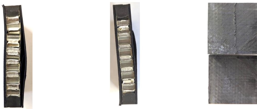
Рисунок 36 – Разрушение образцов с глубиной укрепления - 5 мм в результате эксперимента
