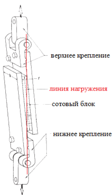
Рисунок 12 – Оснастка для испытания на сдвиг сотового заполнителя: а) схема нагружения по ASTM C 273-00, б) оснастка по СТО СМК 7-158-2023 ФАУ «ЦАГИ»
