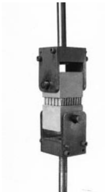
Рисунок 10 – Примеры оснасток для испытания трехслойных материалов на растяжение
