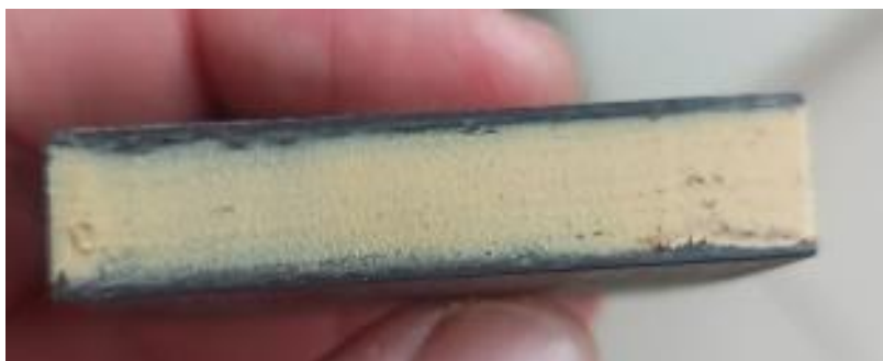
Рисунок 44 – Фотография образца с упрочненными торцевыми гранями для проведения испытаний на торцевое сжатие
