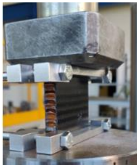
Рисунок 25 – Образец в испытательной оснастке по СТО СМК 7-160-2023
