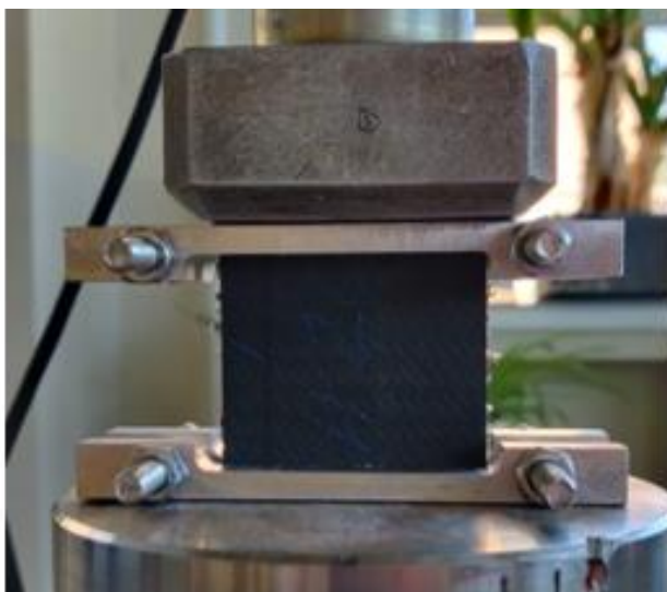
Рисунок 25 – Образец в испытательной оснастке по СТО СМК 7-160-2023
