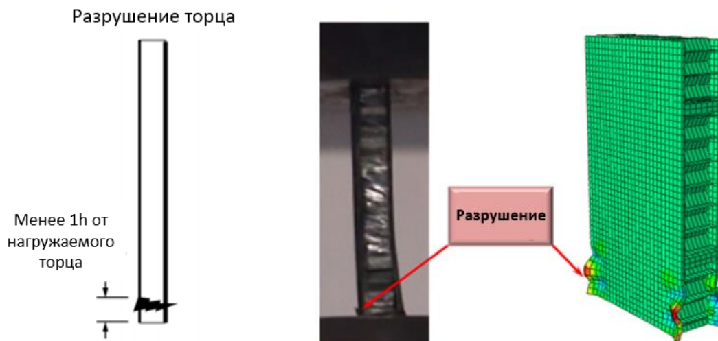
Рисунок 26 – Незачетное разрушение образца при торцевом сжатии
