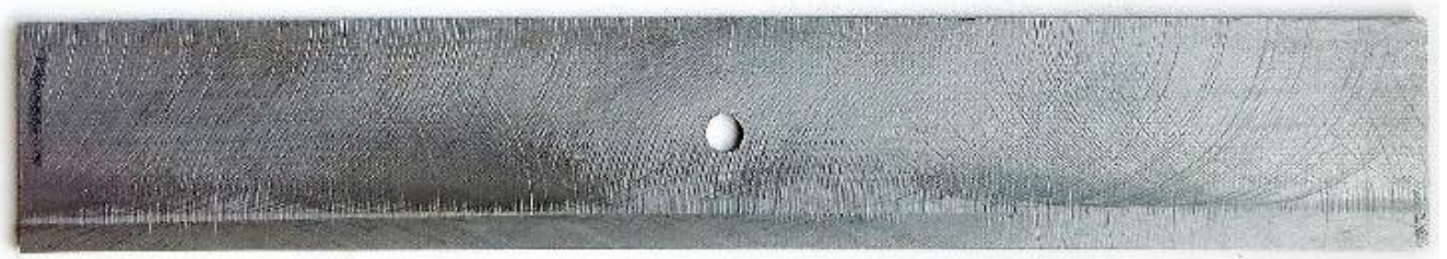
Рисунок 2.11 – Типовой вид образца до усталостных испытаний
