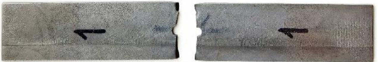
Рисунок 2.15 – Типовой вид образца после усталостных испытаний
