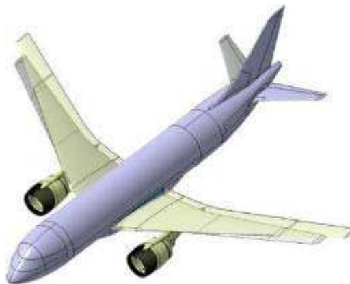
Рисунок 2.48 – Новое крыло ДМС-21-1 на фюзеляже М2Ф21/Ф31
