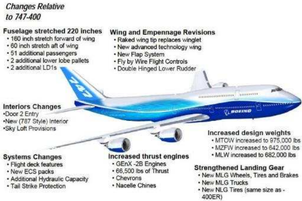
Рисунок 2.34 – Основные изменения в самолёте Б747-8 [183]
