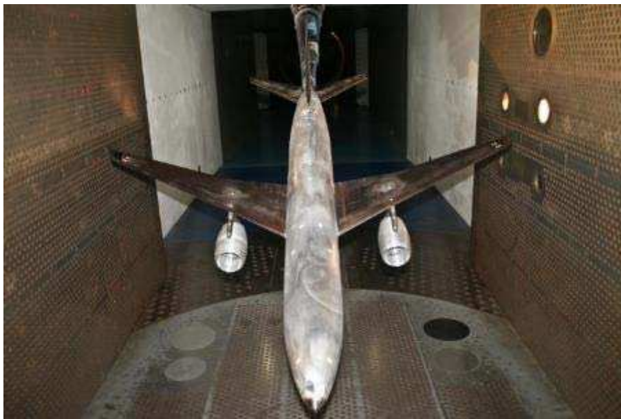
Рисунок 2.40 – Модель перспективного ДМС с крылом 1 в АДТ Т-128
