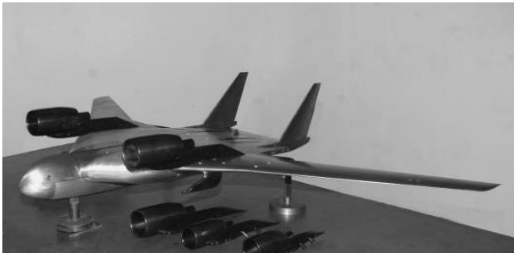
Рисунок 4.21 – Аэродинамическая модель ЛК-2011 с расположением двигателей над крылом
