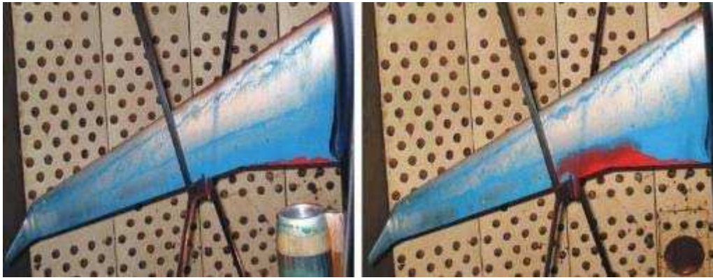
Рисунок 4.23- Визуализация обтекания методом цветной масляной пленки в АДТ Т-106М
