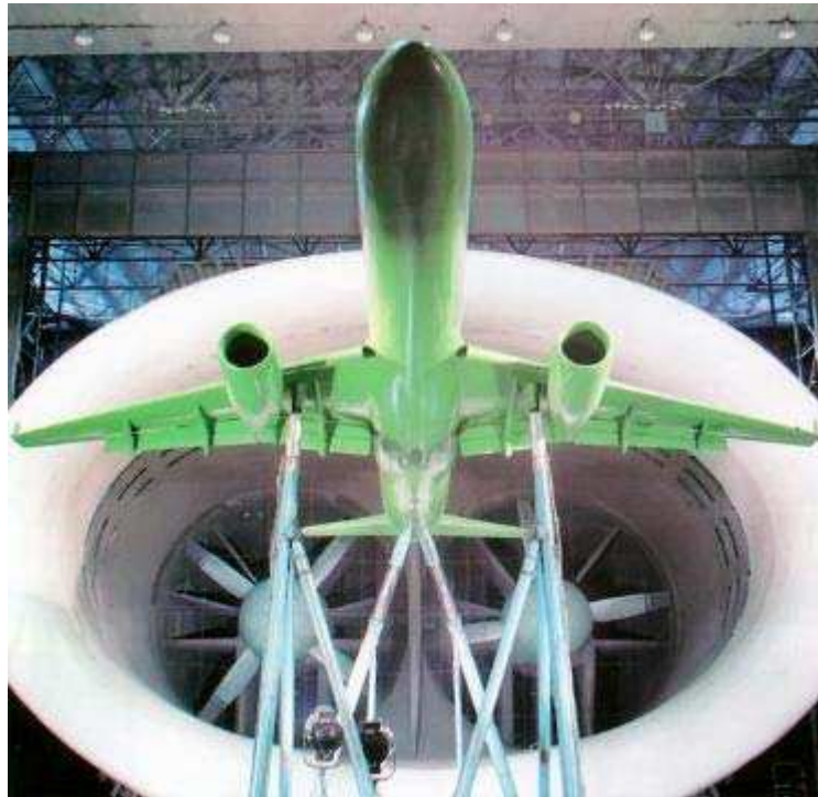
Рисунок 9 – 1/3 масштабная модель самолёта Ту-204 в большой дозвуковой АДТ Т-101
