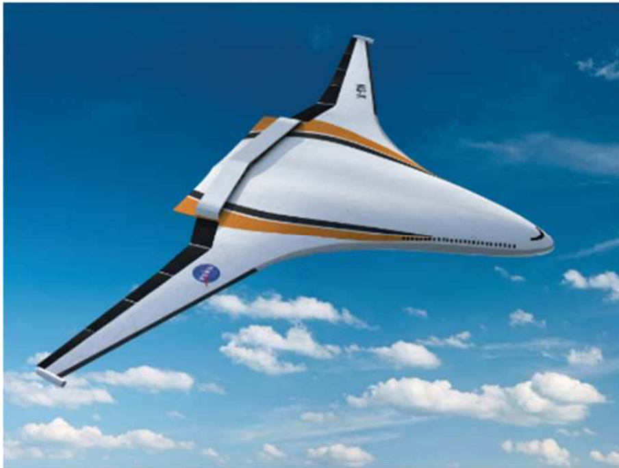
Рисунок 4.15 – BWB с распределенной турбоэлектрической силовой установкой, проект NASA [194]
