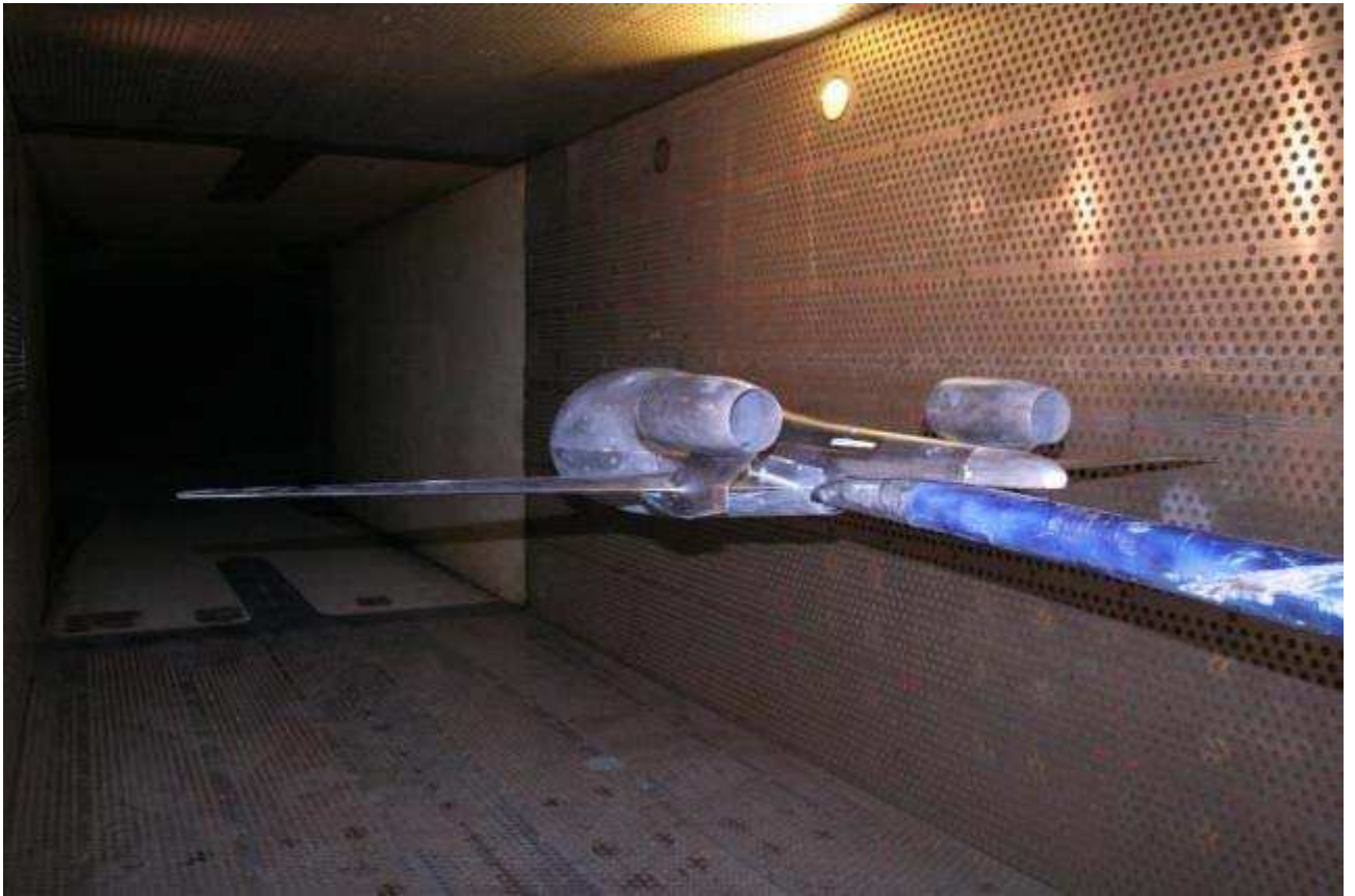
Рисунок 3.55 – Модель административного самолёта в компоновке без хвостового оперения в АДТ Т-128
