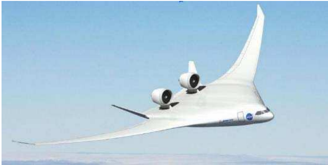
Рисунок 4.13 – Проект ДМС в схеме BWB фирмы Боинг [193]
