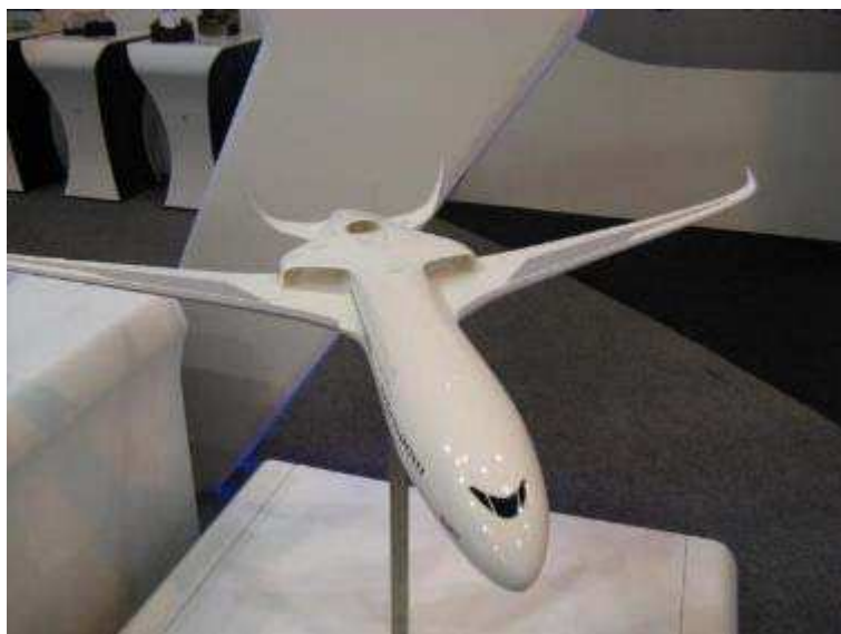
Рисунок 4.17 – Перспективный БСМС с турбоэлектрической силовой установкой, проект AIRBUS
