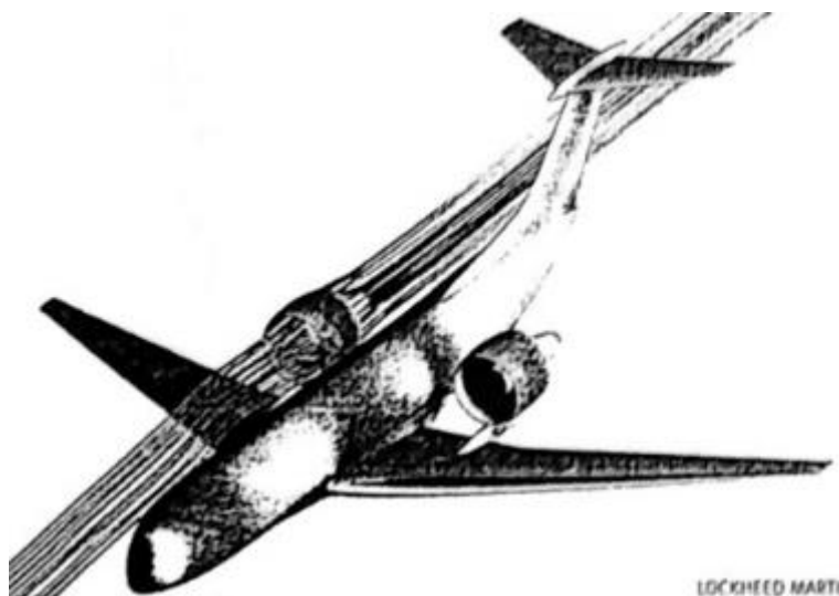
Рисунок 3.46 – Концепция пассажирского самолёта с ТРДД сверхвысокой степени двухконтурности над крылом фирмы Локхид-Мартин [188]
