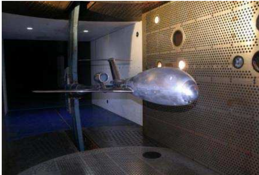
Рисунок 3.54 – Модель административного самолёта в полной компоновке в АДТ Т-128
