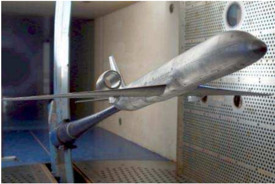
Рисунок 3.47 – Модель ЦАГИ регионального самолёта с надкрыльевым положением мотогондол в АДТ Т-128
