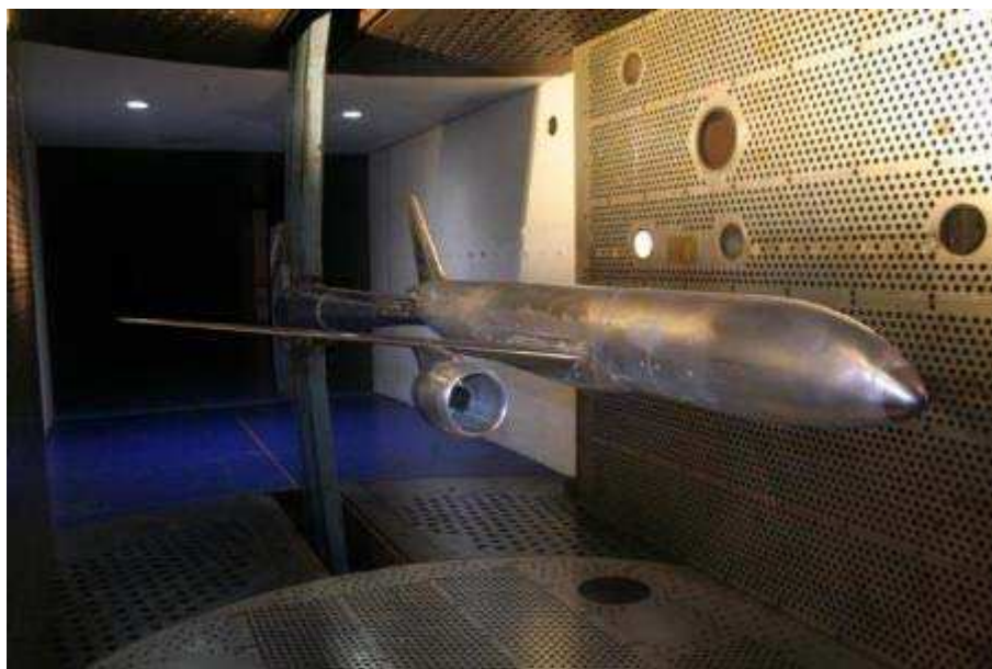
Рисунок 2.62 – Полная модель ШФДМС с исходной законцовкой
