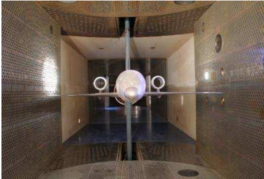
Рисунок 4.45 – Модель с крылом 3 малой стреловидности в АДТ Т-128
