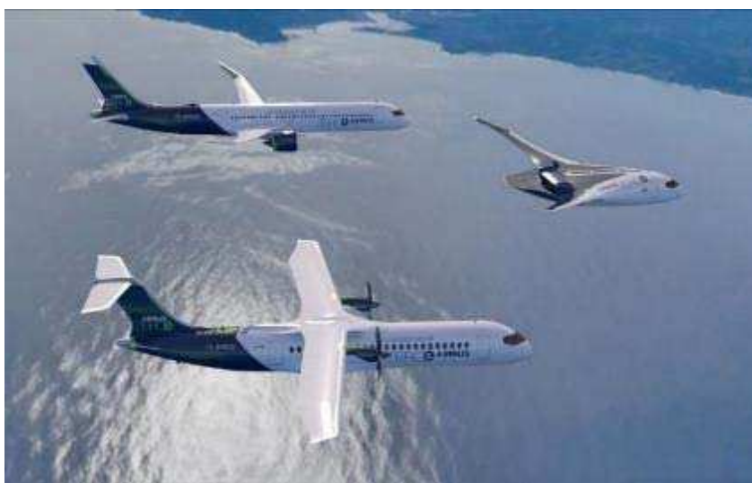
Рисунок 14 – Концепты Airbus использованием жидкого водорода
