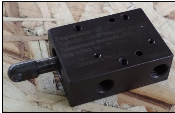
Рисунок П2.12 – Изготовленный рабочий образец гидроцилиндра
