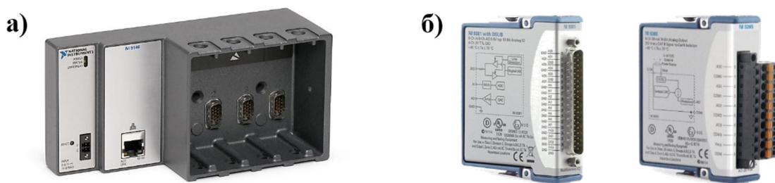
Рисунок П2.20 – Универсальное шасси cRIO–9063 (а) и multifunctional модули ввода–вывода CompactRIO (б)
