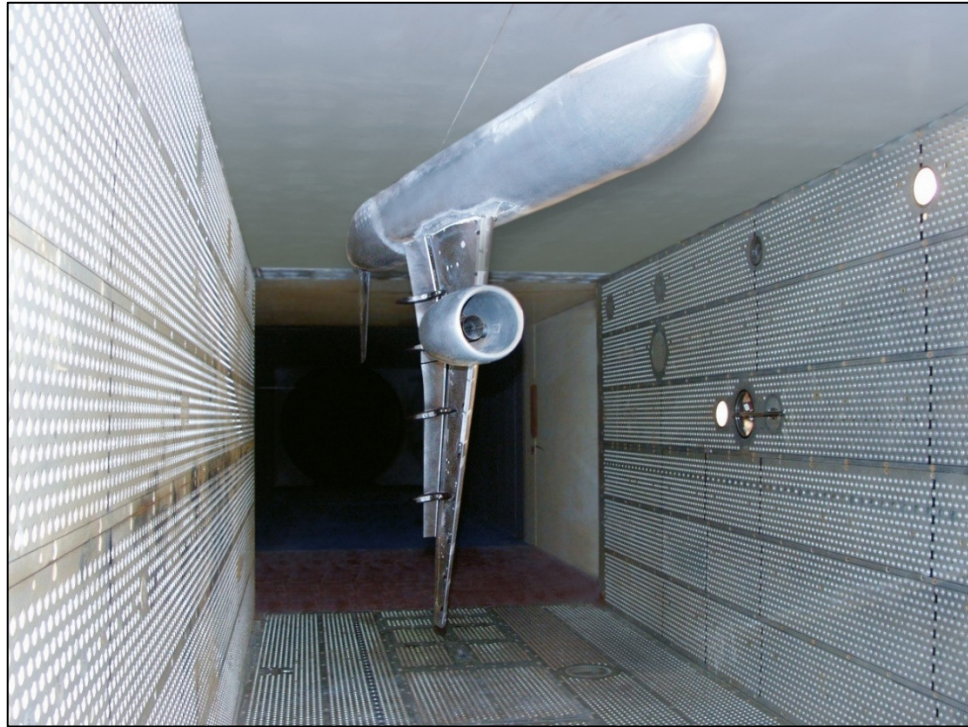
Рисунок 1.8 – Крупноразмерная полумоделю магистрального самолета в Т-128
