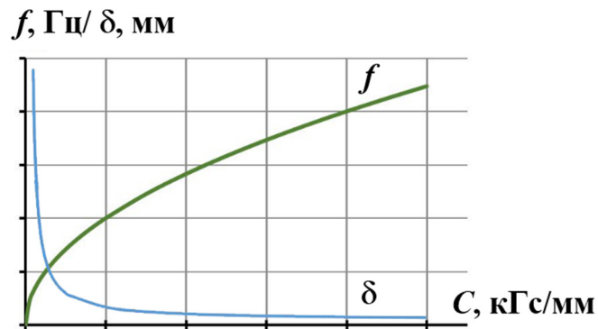
Рисунок 2.33 – Зависимость частоты собственных колебаний и прогиба измерительного блока от жесткости системы
