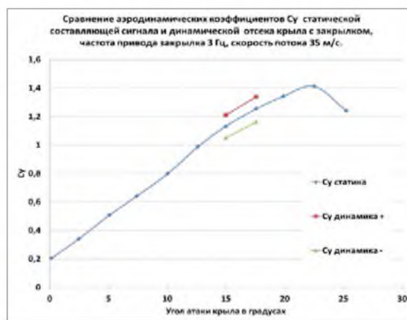
Рис. 8. - Статическая составляющая сигнала коэффициента подъемной силы C_y и динамическая составляющая сигнала в положительной и отрицательной полуплоскостях, частота привода закрылка 3 Гц, скорость потока V=35 м/с.
