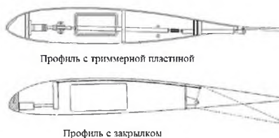
Рис. 9. - Профиль лопасти винта с триммером вне профиля и с закрылком
