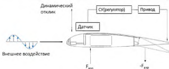
Рис. 16 - Концепция активного демпфирования колебаний лопасти с использованием обратных связей
