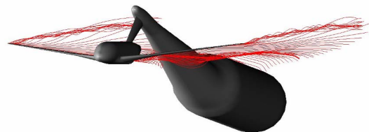
Взаимодействие вихревой пелены и килевой державки
